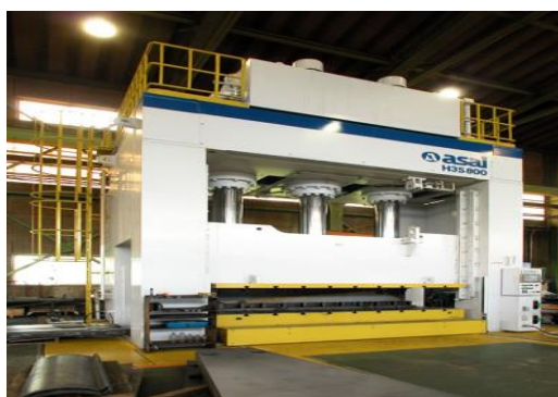
(清鋼材) 工場内観 (800t 油圧プレス機)
