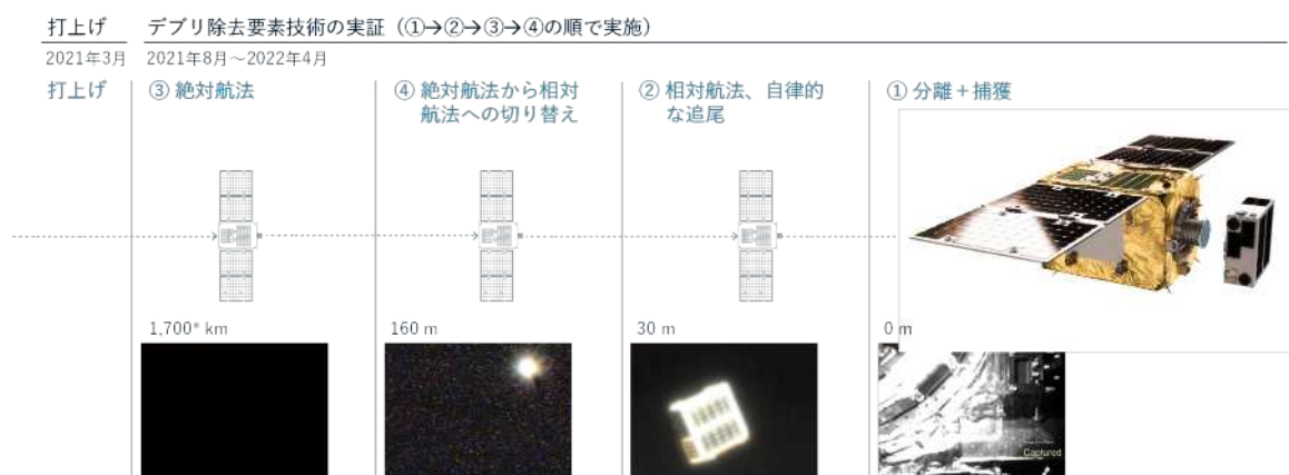
図26 ELSA-dの宇宙実証の内容 (*はサービサーとクライアントの距離)
