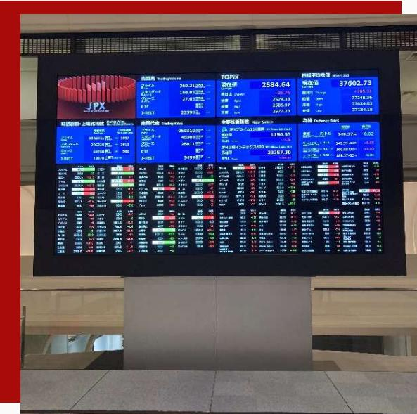
マーケットセンターの中に見える大きな株価ボード：マルチディスプレイは70インチの大型モニターを16台組み合わせてある巨大なモニターで、東証での取引に関連する様々な情報を表示しているものです。
