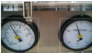
画像解析により数値が自動で読み取られデジタルデータとして保存
